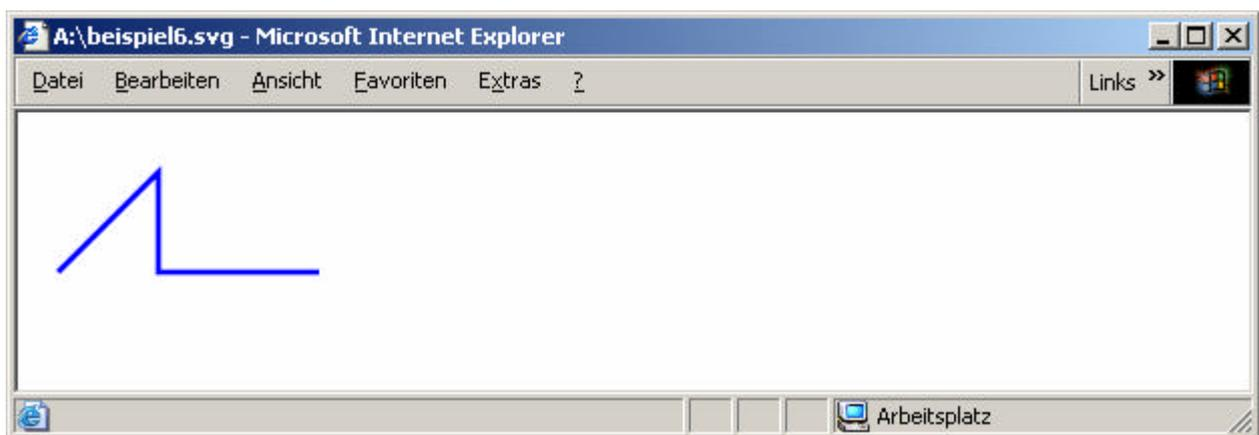
Abbildung 29: Verwendung der Punktbefehle moveto, lineto, horizontal und vertical lineto
