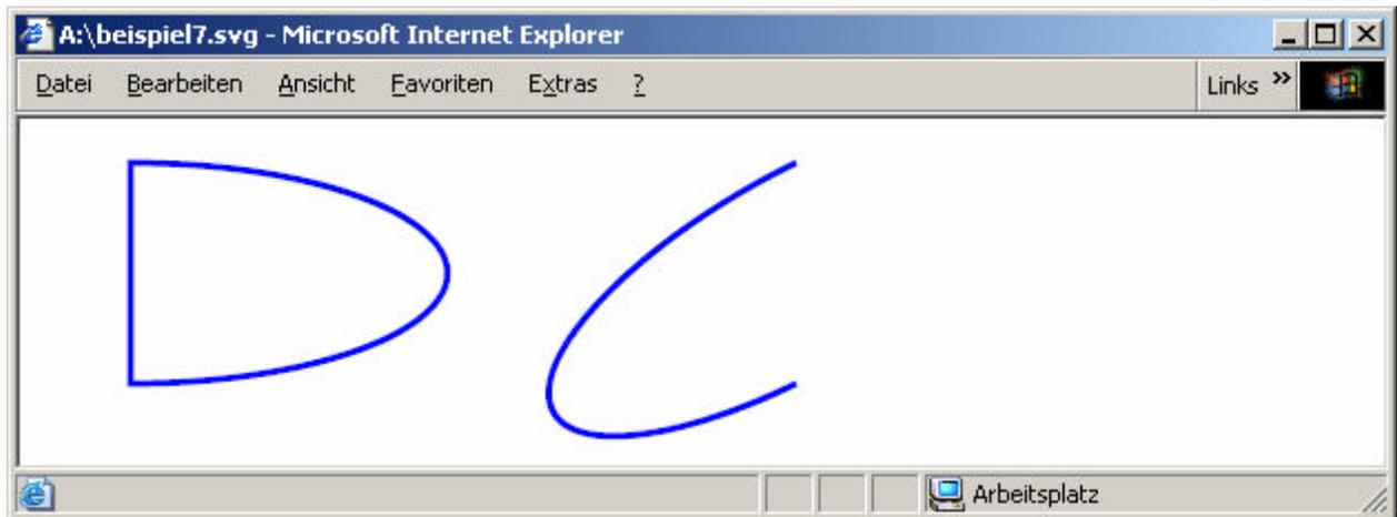
Abbildung 30: Verwendung der Punktbefehle elliptical arc und closepath
