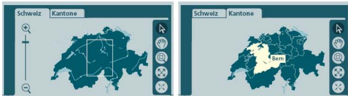
Abb. 5.6: Räumliche Navigation mittels verschiedener Referenzkarten
