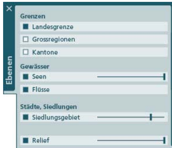
Abb. 5.9: Panel Ebenenkontrolle mit Transparenz-Slidern
