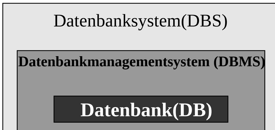
Abbildung 29: Aufbau eines DBS (aus: Däßler, 2001)
